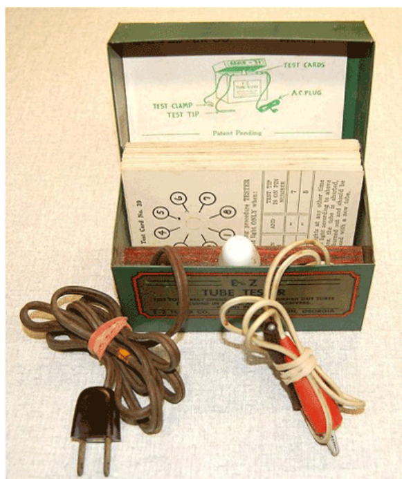
Catometrul „EZ” verifica cu o tensiune alternativa de 110V conexiunile de filament.
