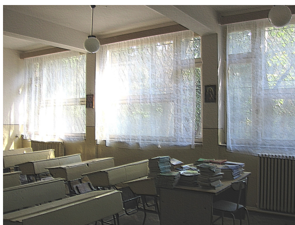
Fig. 8. Pupitrele obișnuite de clasă au schelet din oțel care împreună cu partea din produse lemnoase poate asigura protecția față de căderea unor lămpi, materiale didactice, tencuiei, geamuri
