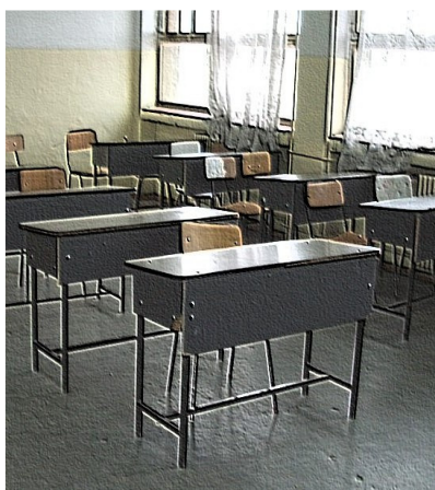
Fig. 8. Pupitrele obișnuite de clasă au schelet din oțel care împreună cu partea din produse lemnoase poate asigura protecția față de căderea unor lămpi, materiale didactice, tencuiei, geamuri
